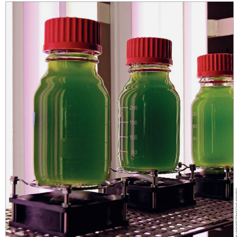
CERTAINES MICROALGUES, comme ici en culture dans ces flacons Chlamydomonas reinhardtii , sont étudiées en laboratoire en vue de produire des biocarburants. Car elles sont dotées d'une enzyme, l'hydrogénase, qui permet de convertir l'énergie solaire en hydrogène.
